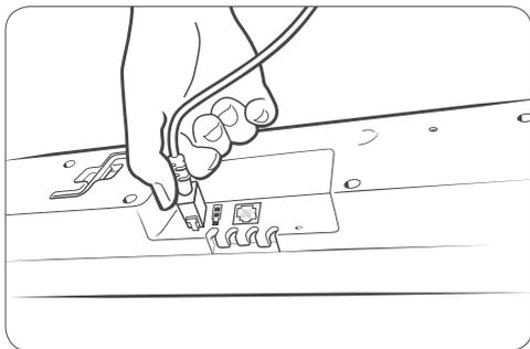
Retirez le lien de fixation des câbles. Branchez l'extrémité de la fiche correcte au moteur et insérez l'autre extrémité dans l'adaptateur. Insérez l'autre fiche dans l'adaptateur.
