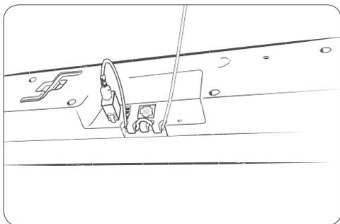
Faites passer le câble autour de l'évidement central. En utilisant l'évidement, vous évitez que la fiche du câble d'alimentation ne soit retirée du moteur et un dysfonctionnement potentiel.
